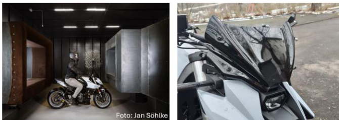
Abbildung 1 – Exemplarischer Versuchsaufbau im Windkanal (links) und montierte Windschutzscheibe (rechts)
