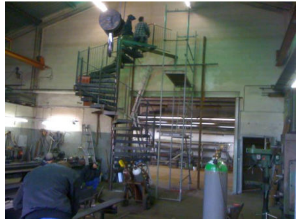
Abbildung 1 – Foto der Erstautorin. Dargestellt ist die Werkshalle des betroffenen Mitarbeiters. Man sieht parallel verlaufende Schweißertätigkeiten. Es ist keine Absaugung vorhanden. Als Absaugung dienen die geöffneten Tore. Die Mitarbeiter tragen nur Schutzbrillen.
