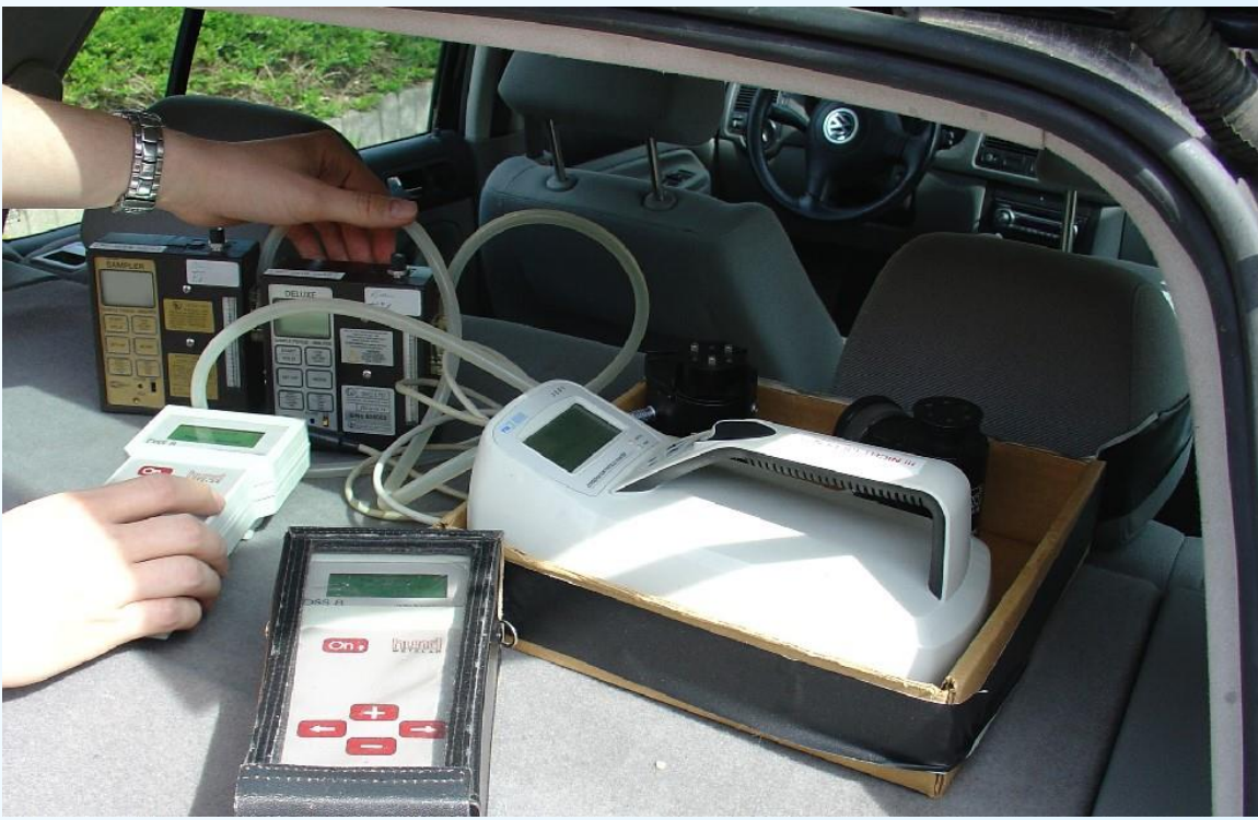
Abbildung 1: Unterschiede der Stauberfassung; Links: Mobile Messgeräte, Rechts: Stationäre Messstation des HLUG in Gießen
