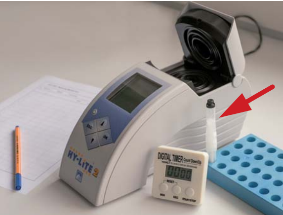
Abb. 1: Messgerät und Messstift (Pfeil) zur Erfassung der ATP-Aktivität mittels Biolumineszenz
